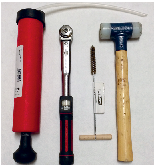
Abb. 41: Werkzeugset mit Drehmomentschlüssel, Ausblaspresse usw. für die Montage der Befestigungspunkte
