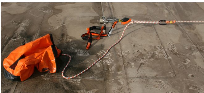
Abb. 11: In temporärem Seilsystem (Life-Line) eingebautes Abseilgerät zum ablassen (rig for rescue)
